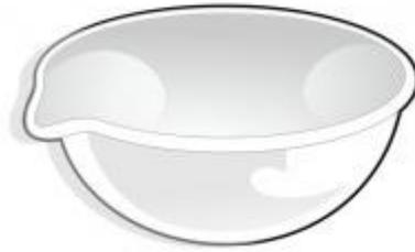
Peça de porcelana utilizada para evaporar líquidos das soluções e na secagem de substâncias. Podem ser utilizadas em estufas até o limite de no máx. 500°C.
