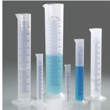
A proveta é utilizada para medição de líquidos para os mais variados fins. Realiza medições diversas e sua fabricação é geralmente em plástico ou vidro. Se comparada a outros instrumentos de laboratório a proveta tem menor precisão e seu uso é mais indicado para análises em que não é necessária uma medição muito precisa.
