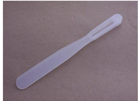
Utilizadas para transferência de sólidos. Podem ser encontradas em aço inox, porcelana, níquel, osso e polipropileno.
