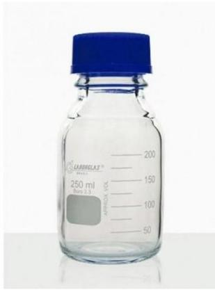
É uma vidraria amplamente utilizada para armazenamento de soluções, preparo de meios de cultura e para coleta de amostras, devido a sua grande resistência a produtos químicos e à variação de temperatura. Esses frascos podem ser autoclavados.
