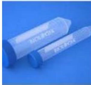
São usados em laboratórios de análises ou de pesquisas, para centrifugação, congelamento e armazenamento de reagentes ou amostras.
