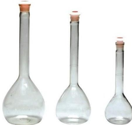
O balão volumétrico é um frasco utilizado para preparação e diluição de soluções com volumes precisos e pré-fixados. Possui um traço de aferição no gargalo. Podem ser feitos de vidro borossilicato e em polipropileno.
