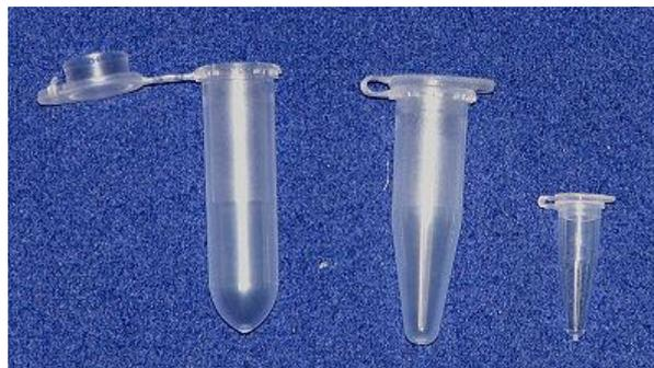
Um tubo de Eppendorf, também designado por tubo de microcentrífuga, é um pequeno tubo de plástico com formato cilíndrico e fundo cônico, com tampa acoplada. Podem suportar temperaturas baixas ( $-20^{\circ}\text{C}$ ) e solventes orgânicos. São muito utilizados na área de Biologia, Química e Bioquímica, para armazenar amostras ou para aplicar em micro centrífugas.
