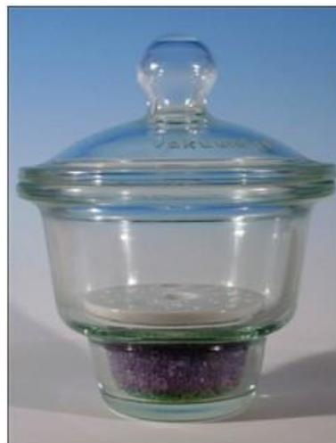
Sua principal função é a de diminuir a umidade de alguma substância (mediante o uso de um agente dessecante, como a sílica gel). A tampa contém uma resina vedante (geralmente, silicone), para que o conteúdo esteja completamente isolado do meio.
