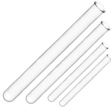
É um recipiente de pequeno porte, utilizado para a realização de experiências com pequenos volumes, e também para armazenar, misturar e coletar amostras. É feito de vidro ou polipropileno, possui forma tubular, longa e estreita, com uma abertura no topo e borda de maior espessura.
