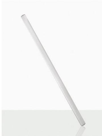
Disponíveis com medidas variadas, os bastões de vidro são utilizados para agitar substâncias e facilitar a homogeneização. Também auxiliam na transferência de líquido de um recipiente para outro.
