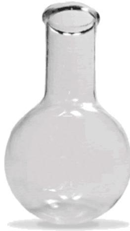
O balão de fundo redondo é utilizado nas destilações químicas é mais apropriado para os aquecimentos sob refluxo. Pode ser aquecido com uma manta aquecedora ou acoplado a evaporador rotativo (rota evaporador).
