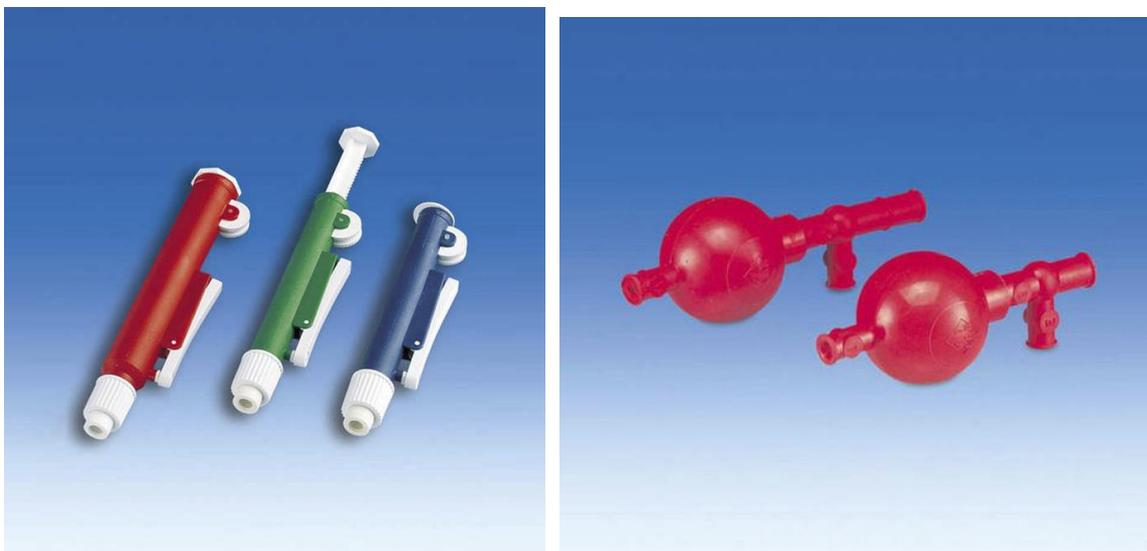
São utilizadas para auxiliar na sucção de líquidos em pipetas. São usadas em procedimentos laboratoriais para evitar que o usuário tenha contato direto com os líquidos manuseados.
