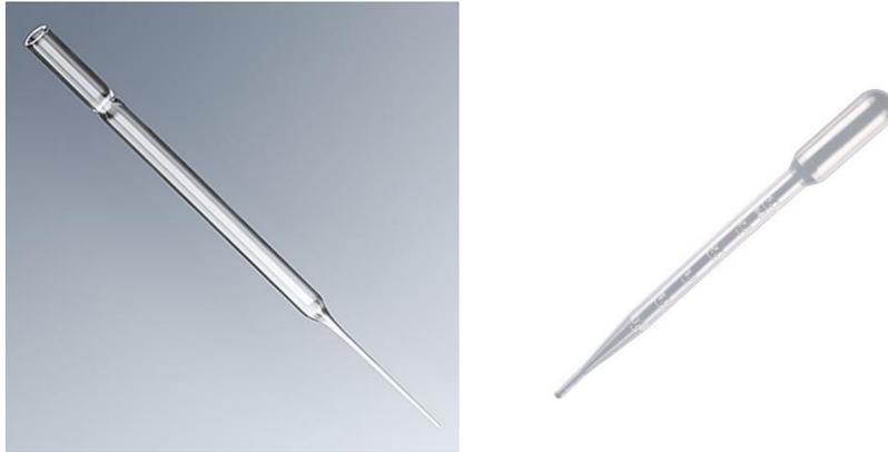
Usada para lavagem de vidrarias com solventes não aquosos ou para transferências de líquidos. Pode ser feita de plástico ou vidro. Não possui precisão.
