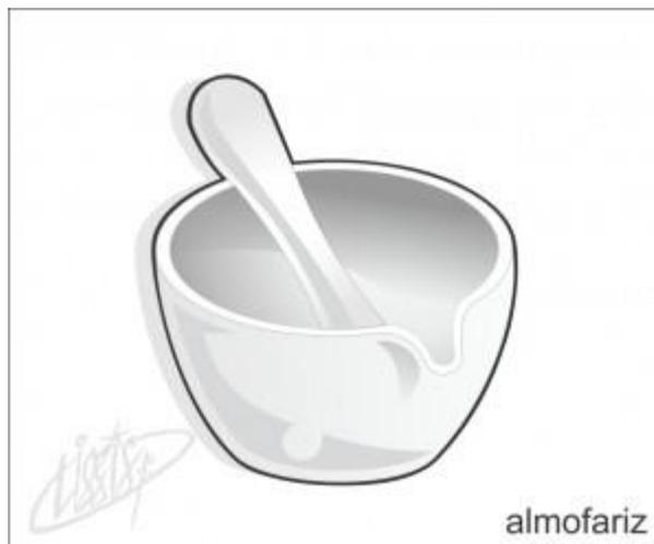
Usado na trituração e pulverização de sólidos em pequena escala. Estes utensílios podem ser feitos de vidro, de cerâmica, de madeira ou de metal. No entanto, os almofarizes mais encontrados em laboratórios são os de cerâmica.
