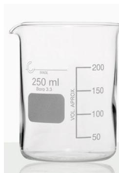
É de uso geral em laboratórios, sendo utilizado para dissolver substâncias, efetuar reações químicas, aquecer líquidos, etc.
